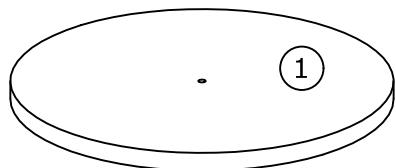
$\varnothing 400 \times 20\text{mm}$
