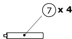
$\varnothing 20 \times 110\text{mm}$
